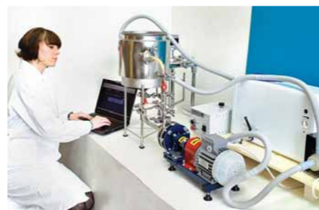
Рис. 1. Установка УПЭС-0.01/0.55 с объёмом рабочей ёмкости 10 литров предназначена для лабораторных, учебных целей и опытных производств. Установка разработана с учётом возможности последующего масштабирования технологического процесса при переходе на установки с ёмкостями большего объёма
