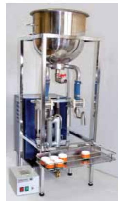
Рис. 5. Установка розлива УД-2П с дополнительной расходной ёмкостью для розлива жидких и пастообразных продуктов малыми дозами
