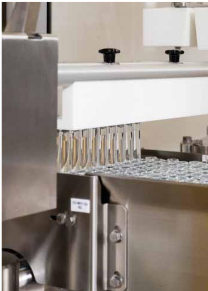
**USD 100 – автоматическая выемка и позиционирование шприцев**
