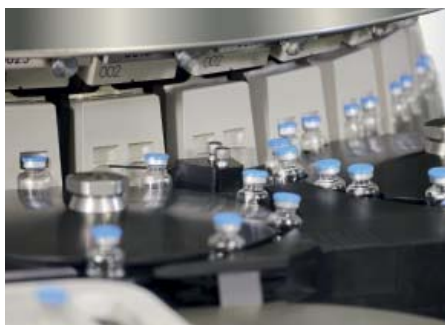
Инспекция стеклянных контейнеров со скоростью до 600 шт./мин. по принципу группового тестирования
