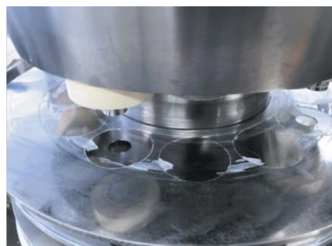
Рисунок 1. Налипание таблеточной массы Ибупрофена с Натрия стеаратом
