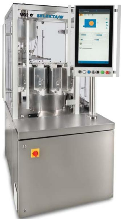
*SELEKTA/W контрольная машина для взвешивания и сортировки таблеток и капсул со скоростью обработки продукции до 160 000 ед./мин. Оснащена новым интерфейсом в соответствии со стандартом Industry 4.0.*
