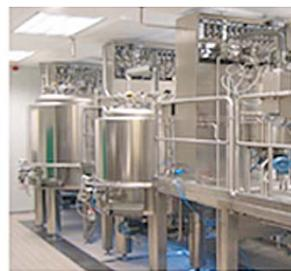
Биореактор культивирования суспензий
