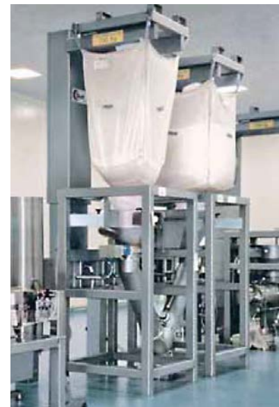
Рис. 3. Прибор фирмы Glatt (Германия) для прямого взвешивания крупных компонентов из мешков и контейнеров
