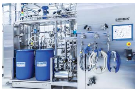
Фото 4. Пример модуля CIP с ручной подачей детергентов
