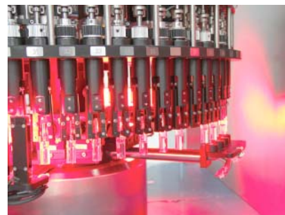
Отбраковка ампул (слева) и флаконов (справа) в два лотка
