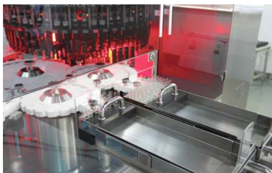
Отбраковка ампул (слева) и флаконов (справа) в два лотка
