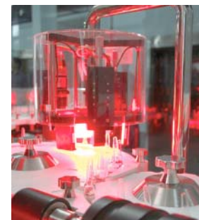
Отбраковка ампул (слева) и флаконов (справа) в два лотка
