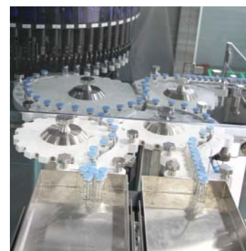
Отбраковка ампул (слева) и флаконов (справа) в два лотка
