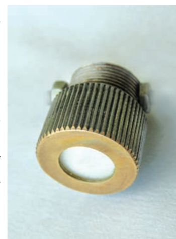
Рис. 1. Цилиндрическая металлическая ячейка Ø 15 мм, h=15 мм с прозрачным дном из оптического стекла. Крышка ячейки и пуансон является мини-прессом
