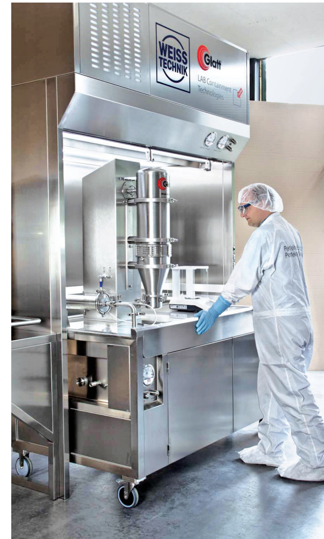
Рис. 5. Установка рабочего стола с размещенной на нем сушилкой Midi-Glatt с псевдооживленным слоем в изолирующий бокс WIBObarrier
