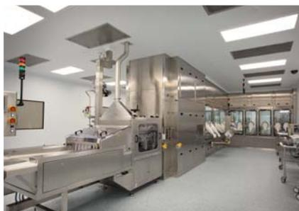
Изоляторы используются во всем мире, и способны интегрироваться со всеми известными видами фармацевтического производственного оборудования, включая машины по наполнению жидкостей/порошков, систему стерилизации продукта электронными лучами, депирогенные тоннели, лиофилизаторы, автоклавы, а также инновационные асептические системы транспортировки.
