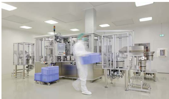
Рис. 6: Новая, полностью автоматизированная сборочная линия СДГК в чистом помещении класса 7 по ISO
