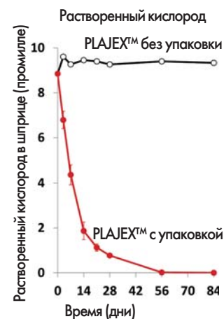
Рисунок 9: (а) Сочетание PLAЈEX™ с дезоксигенированной системой упаковки. (б) профиль снижения растворенного кислорода в заполненных водой предварительно наполненных шприцах. Растворенный кислород измеряли с помощью OXY-4 (PreSens). Данные представлены в виде средней величины \pm среднее квадратическое отклонение ( n = 3 ).
