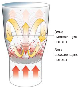
Рис. 4. Расположение форсунки и схема движения восходящего и нисходящего потоков в установке Wurster с распылением снизу
