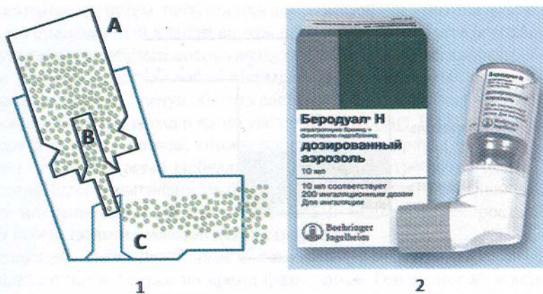
Рис. 5. Схема (1) и внешний вид (2) классического индивидуального дозированного аэрозольного ингалятора: А — баллон; В — клапан; С — мундштук
