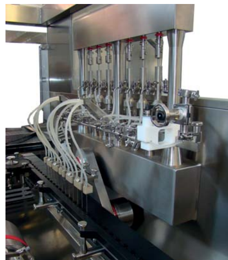
Наполнение флаконов при помощи ротационно-поршневых насосов
